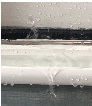
Foto 1. Campione sottoposto a prova durante i test di tenuta all'acqua
