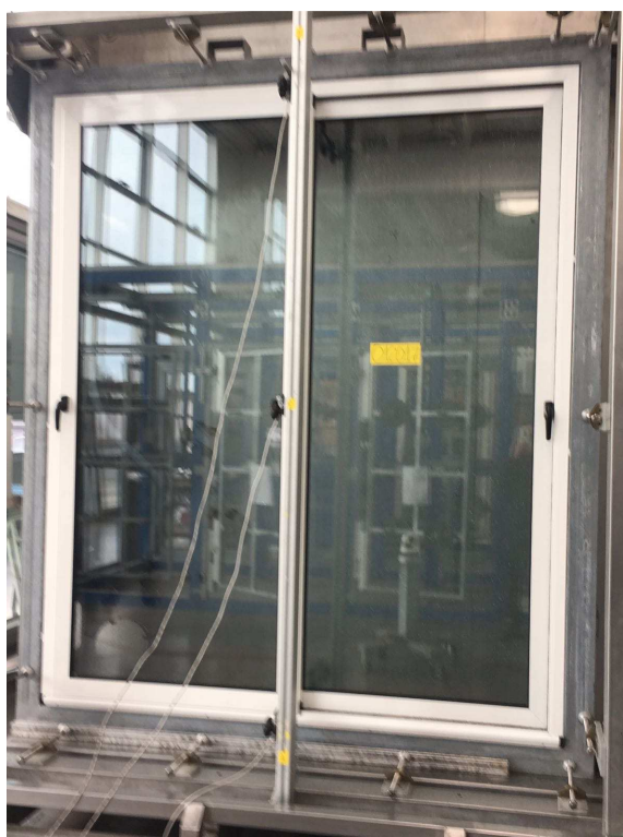
Foto 2. Campione sottoposto a prova durante i test di resistenza al carico del vento
